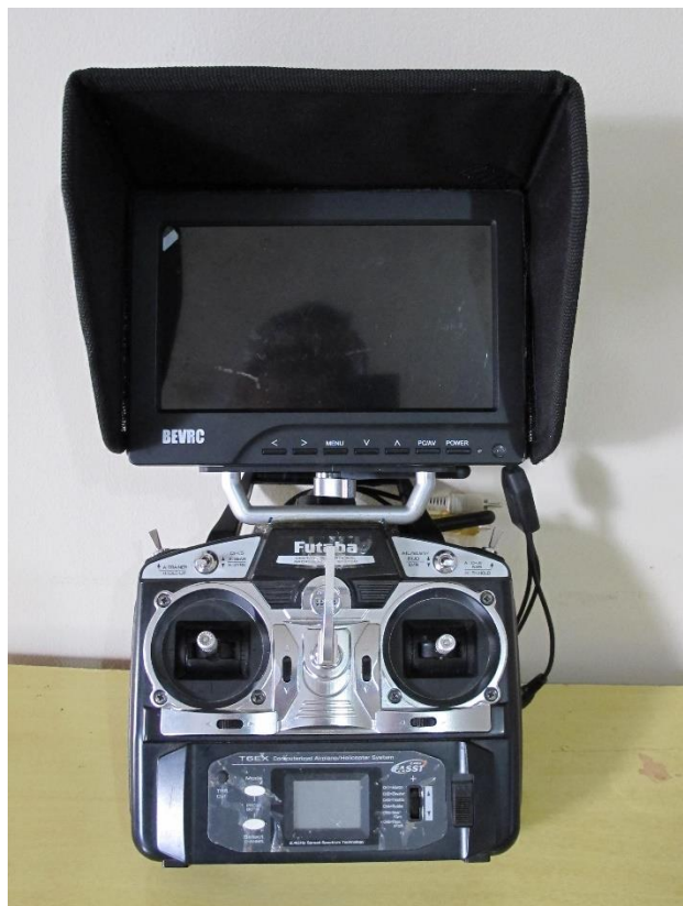
Figura 7 – Rádio-controle de seis canais, com monitor acoplado. Fonte: Evânio S. Branquinho, 27 maio 2020.
