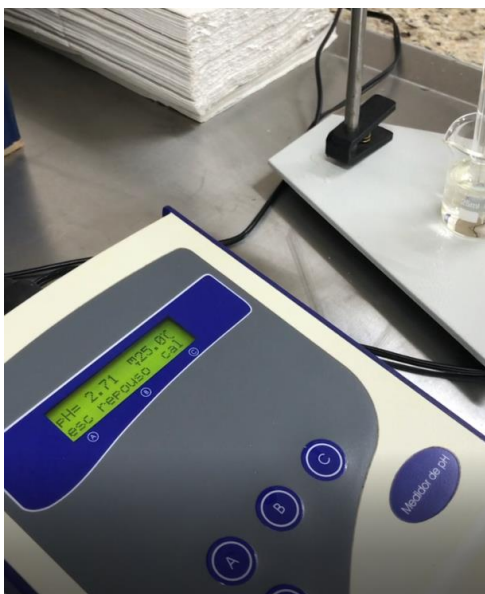
Figura 22 – Determinação de pH do líquido de cobertura após processamento térmico.
