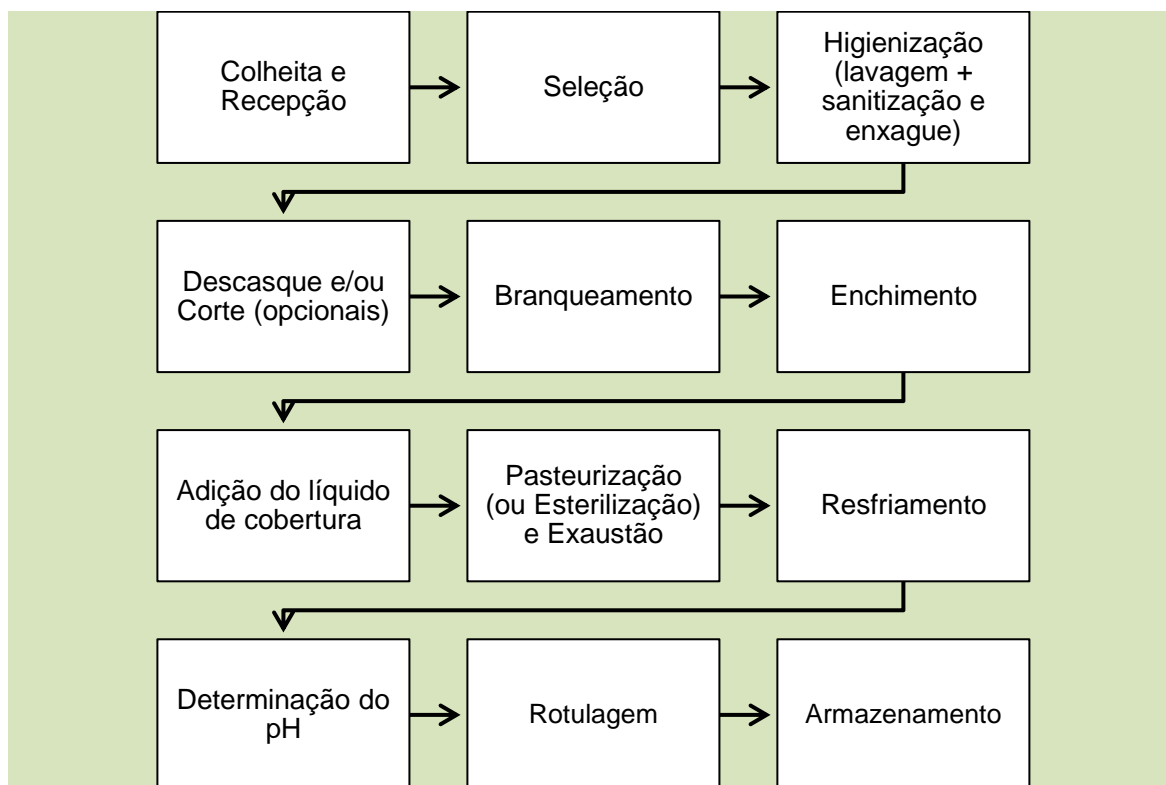
Figura 19 – Fluxograma geral de produção de hortaliça em conserva. Fonte: Adaptado de Krolow (2006).
