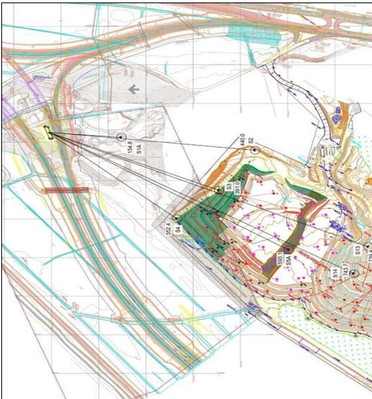
Figura 17 - Disposição sismógrafos em um evento de detonação.
