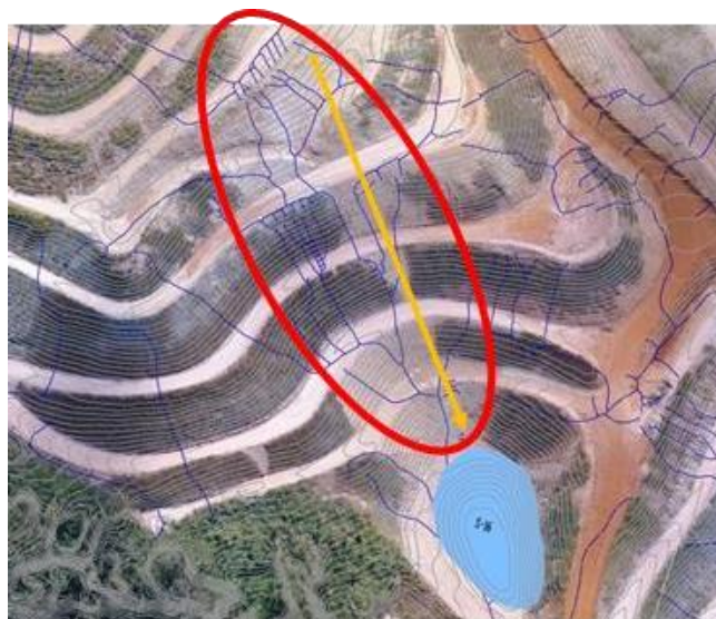
Figura 13: Linhas de Fluxo na parte média do Pit Norte, a montante do Sump 16.
