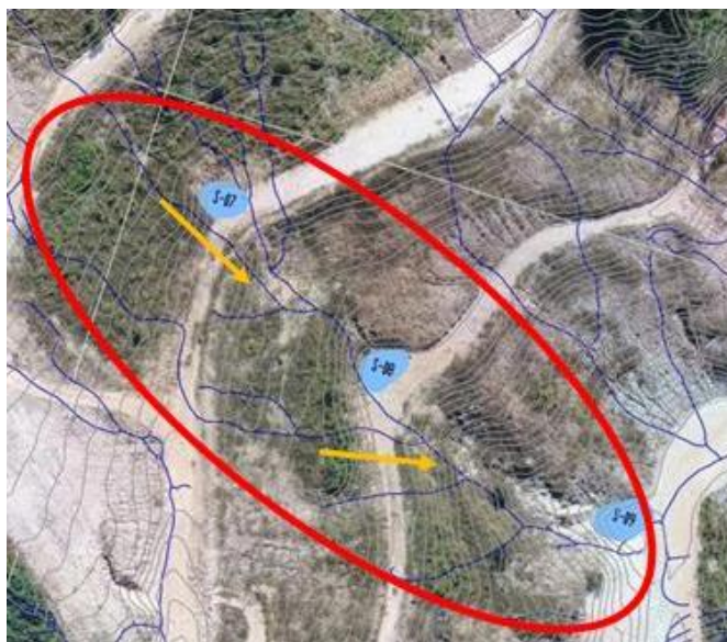
Figura 13: Linhas de Fluxo na parte média do Pit Norte, a montante do Sump 16.
