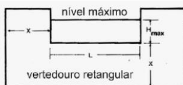
Figura 10: Desenho esquemático do vertedouro retangular com indicação da fórmula de cálculo
