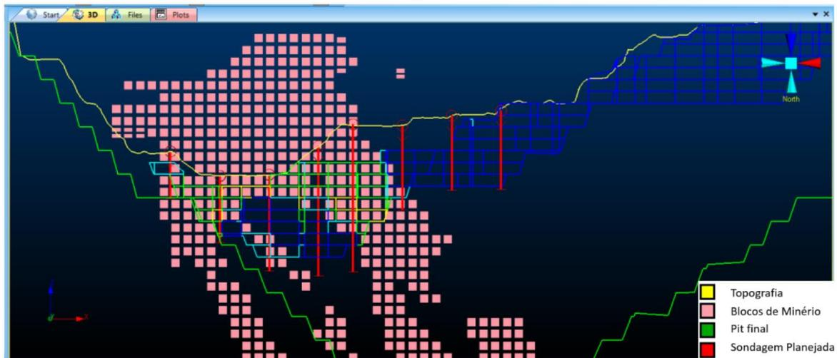
Figura 07: Exemplo de programação de sondagem *infill*.
