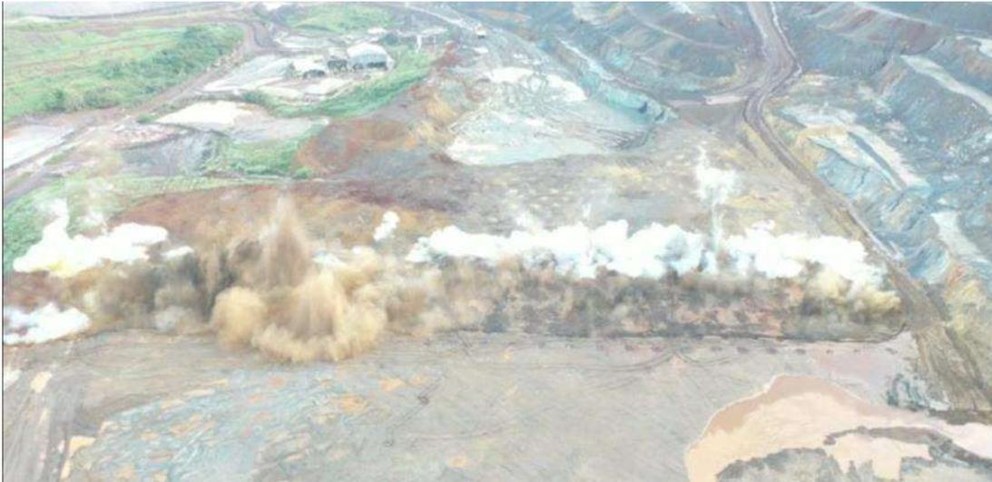
Figura 14: Execução de desmonte
