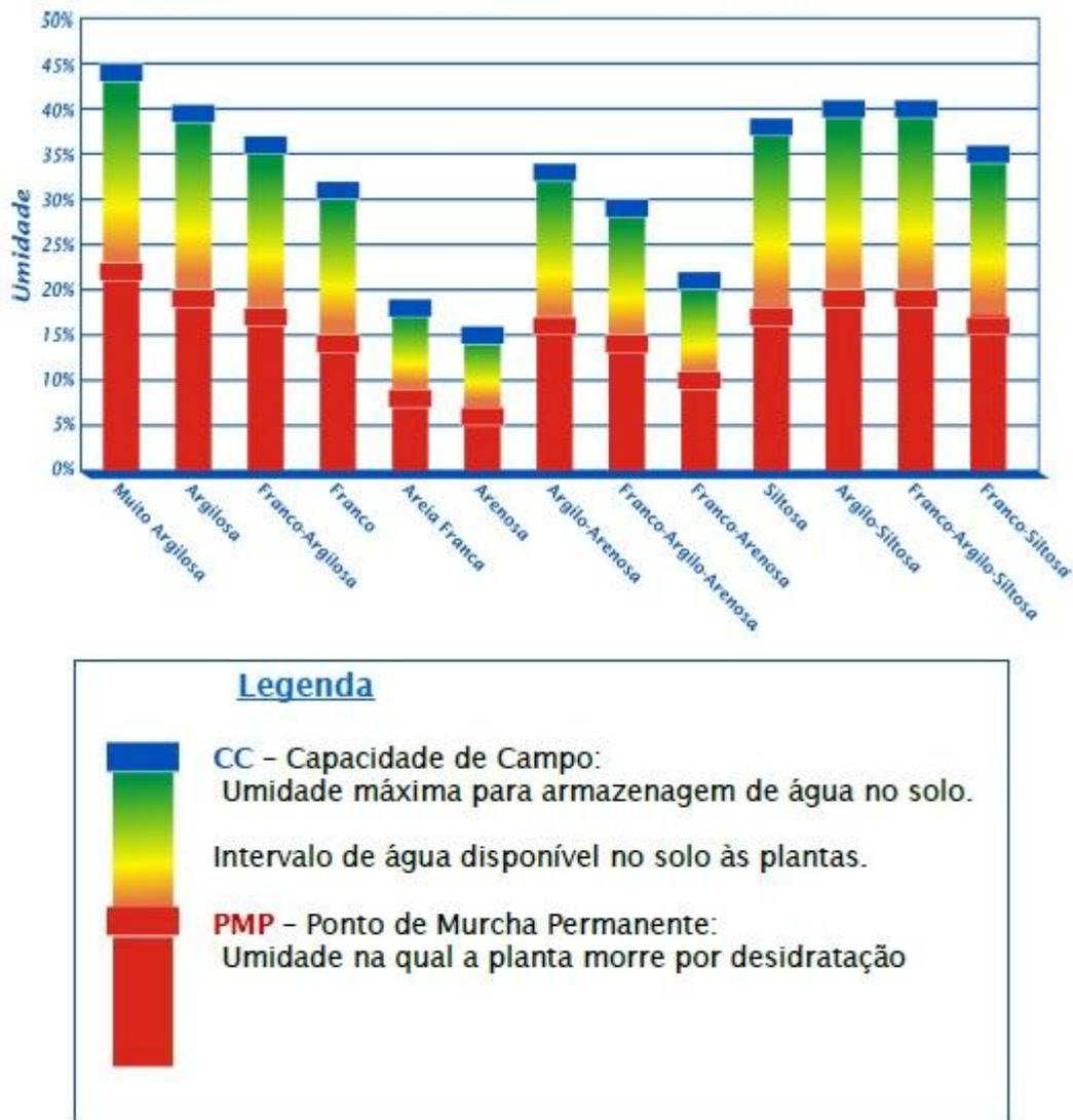
Figura 2 - Intervalo do teor de umidade para as classes de solo. Fonte: Falker, 2010, pág.3.
