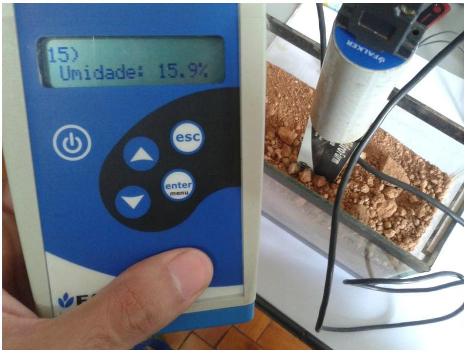
Figura 46 - Resultado apresentado pelo sensor HidroFarm.
