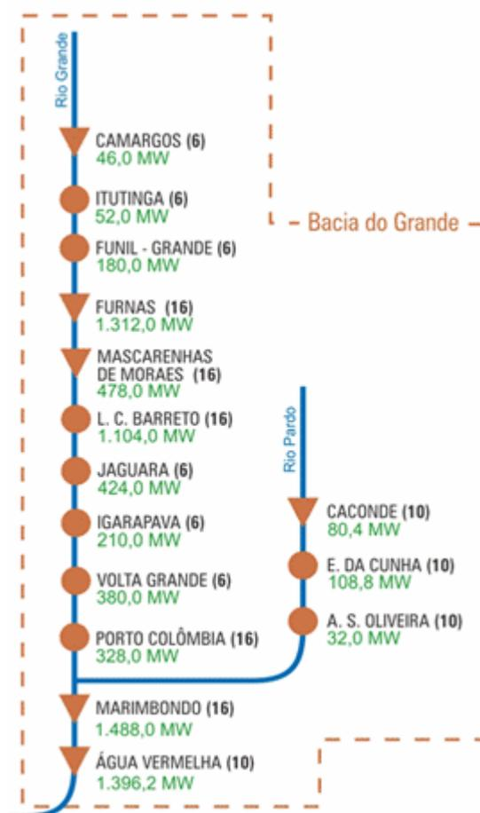
**Figura 13 - Diagrama Esquemático da Bacia do Rio Grande (Operador Nacional do Sistema, 2011)**
