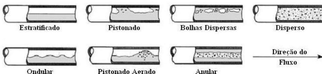
**Figura 3** – Padrões de Escoamento Horizontal gás/líquido.
