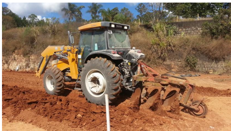
Figura 21 - Trator Valtra PCA 800 revolvendo com o arado.
