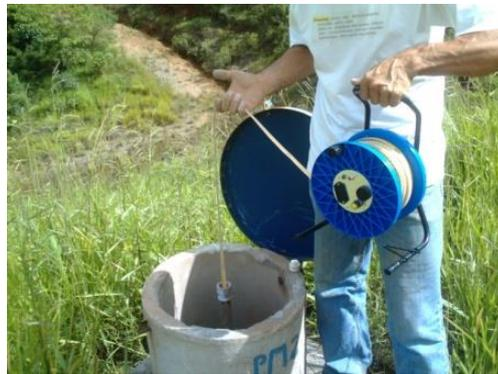
Figura 9: Verificação do “NA” (nível da água) através de medidor.
