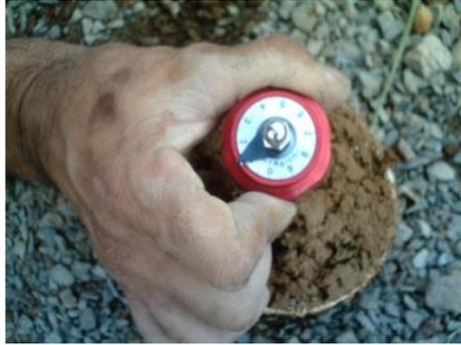
Figura 8: Determinação da coesão do solo pelo ensaio de “Palheta” (Vane Test).
