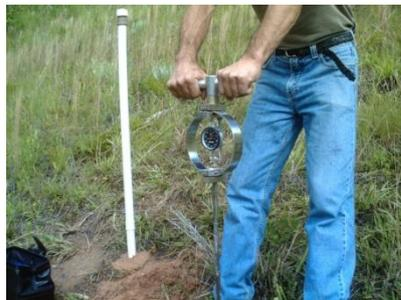
Figura 7: Ensaio de campo para determinação de parâmetros de resistência do solo.
