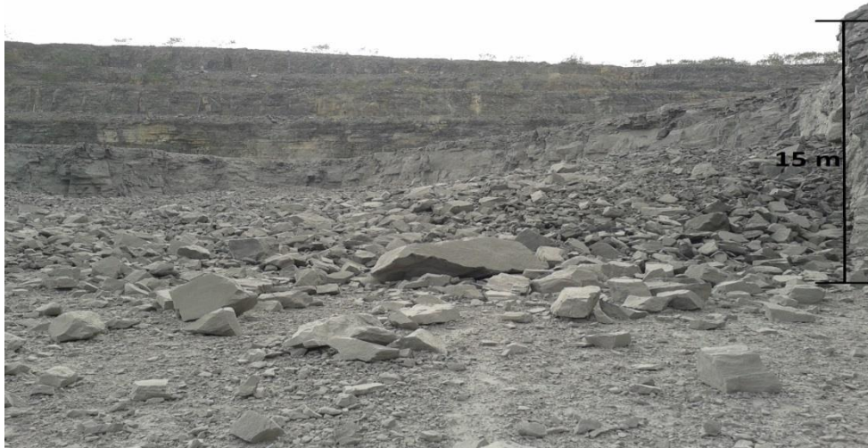
Figura 6- Resultado do desmonte utilizando o Plano de Fogo B.
