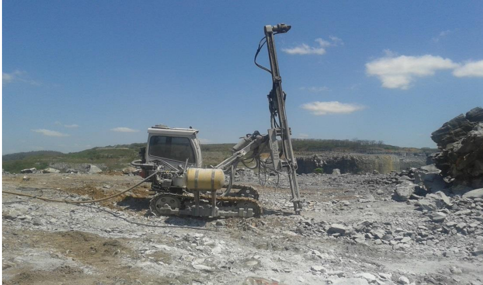
Figura 2-Perfuratriz pneumática utilizada na lavra de calcário.
