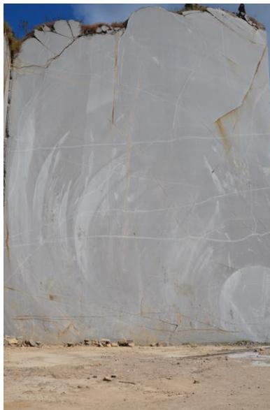
Figura 19 – Sistemas de fraturas em conjuntos com sistemas de veios de feldspato. Obs: Bancada com 8 m de altura.
