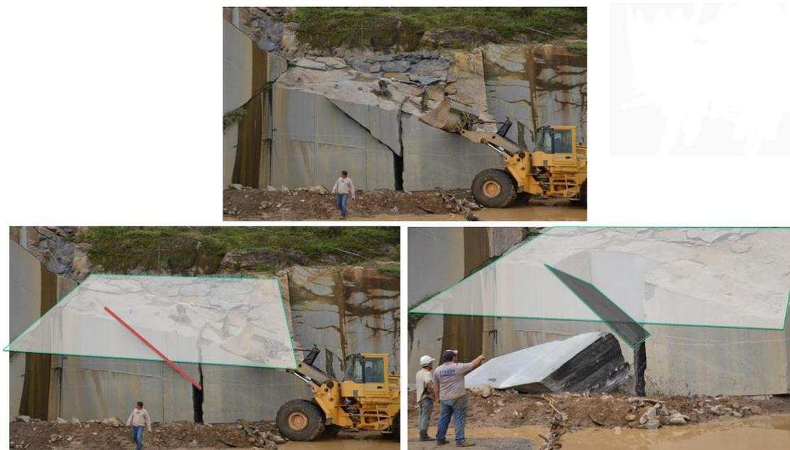
Figura 14 – Aspecto do fraturamento na Área 6, marcado pelo cruzamento das fraturas NE-SW (plano maior) com as fraturas de direção N-S.
