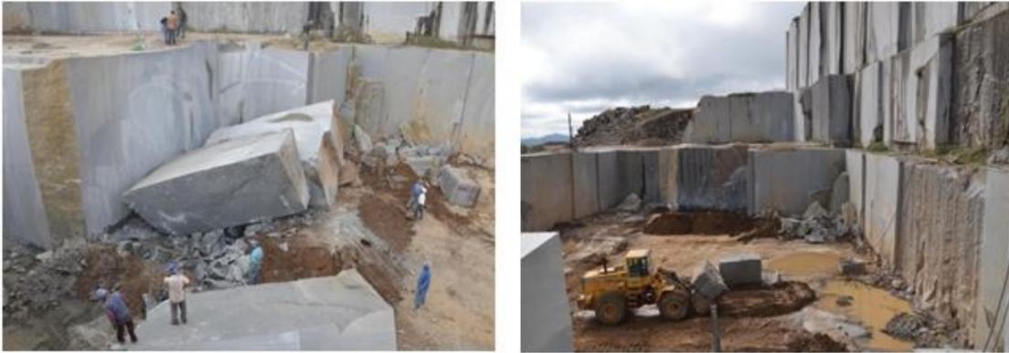
Figura 8 – À esquerda, liberação de bloco por desmonte primário. À direita, bancadas na praça principal. Mina vargem dos Trigos da Empresa ETGRAN, Caldas/MG.
