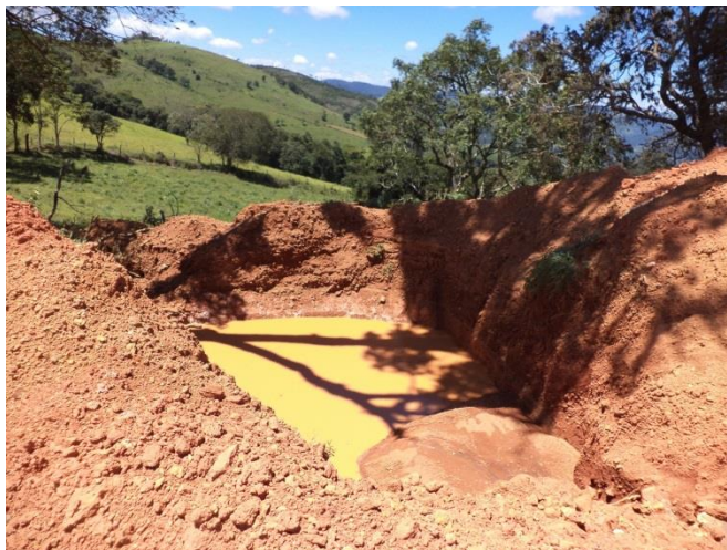
Figura 8: Poço de contenção em uma mina de bauxita na região de Poços de Caldas.
