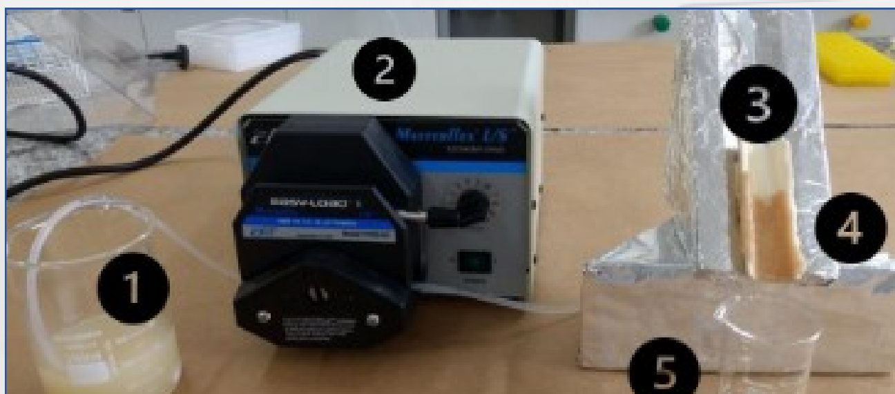
Aparato para determinação da retenção de formulações em mucosa. (1) Muco artificial, (2) Bomba peristáltica, (3) Tubo plástico, (4) Substrato: ágar ou mucosa excisada, (5) Frasco coletor (Naves et al, 2028)
