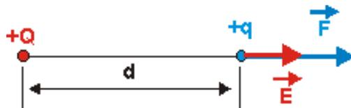
A força elétrica “ $F$ ”, ao deslocar a carga  $q$  no sentido da força, realiza um trabalho ( $\tau > 0$ ). Para aproximarmos a carga  $q$  da carga fixa  $Q$ , temos que realizar um trabalho contra a força de campo para colocar a carga de prova numa posição não-natural.
