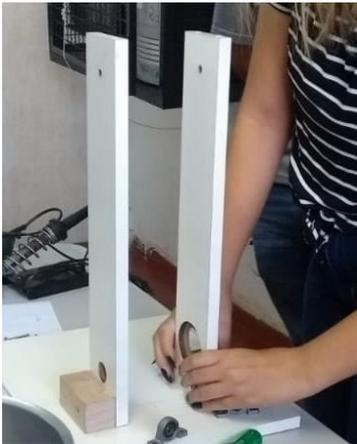
*Figura 9- Fixação das colunas de sustentação*
