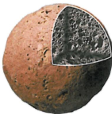
**Figura 1.** Estrutura de uma esfera de argila expandida mostrando a capa superficial e os microporos internos.
