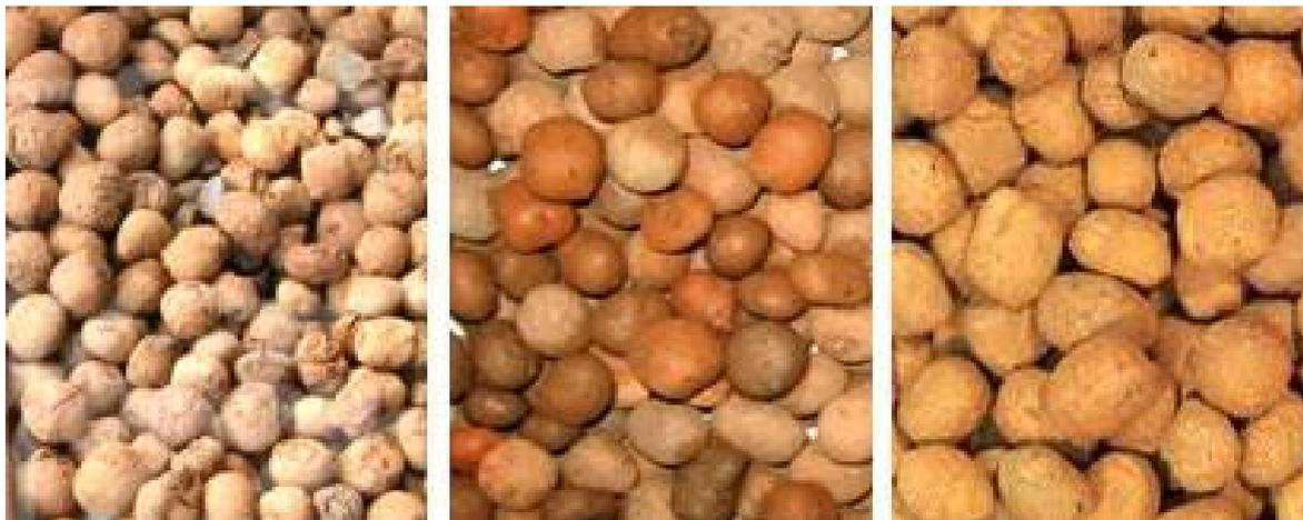
**Figura 3.** Diferentes granulometrias de argila expandida.
