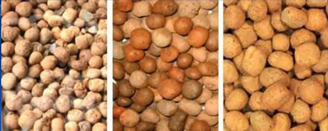
**Figura 4: Argila expandida com diferentes granulometria**
