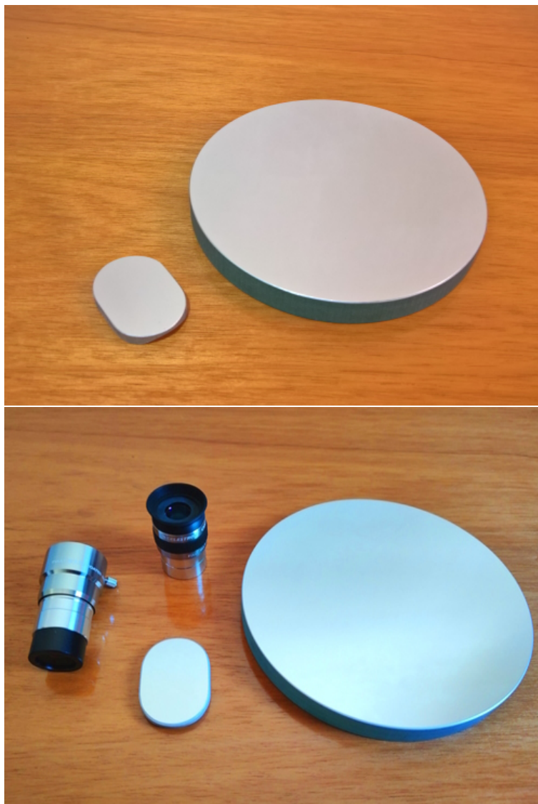
Figura 6 – Espelho Primário Básico e o Espelho Primário Intermediário Fonte: (FILHO, 2018)
