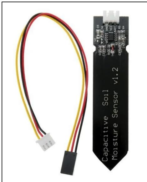
Figura 10 - Sensor de umidade do solo capacitivo v1.2.
