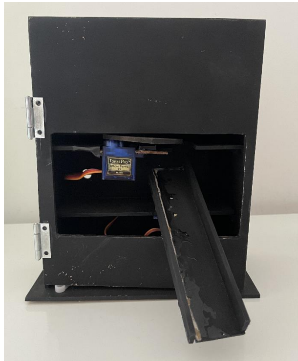
Figura 32: Separador de grãos.
