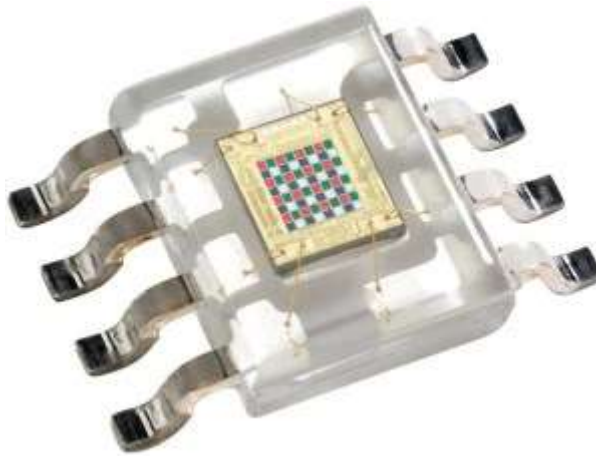
Figura 5 - Chip TCS3200 com seus 64 fotodiodos.
