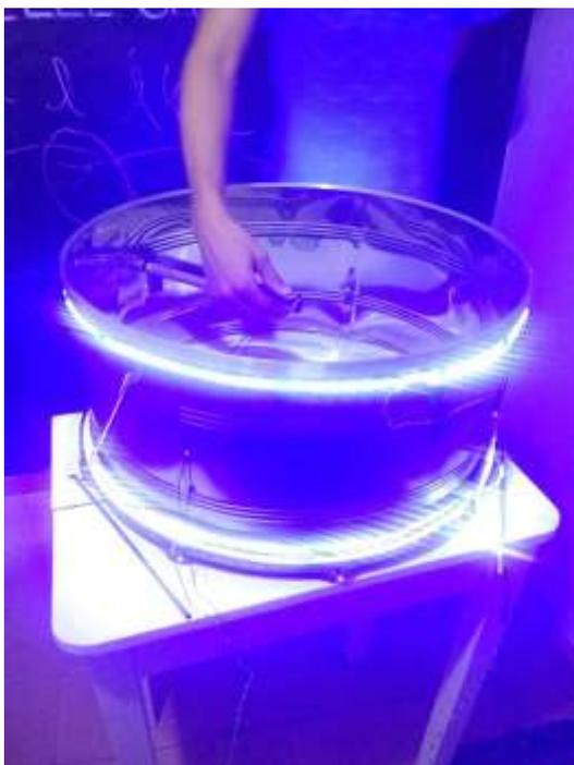
Figura 20 - Ao se pressionar a pastilha piezo elétrica no interior do surdo, ocorre o acionamento da fita de LED's. A pastilha se encontra acoplada em uma chapa metálica de formato "L", evitando assim o seu deslocamento e um possível estímulo mecânico involuntário.
