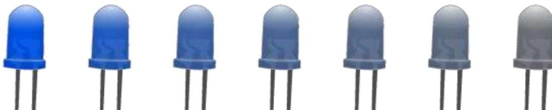
Figura 15 - Demonstração do efeito *fader* em um único LED. Da esquerda para a direita, apresentam-se os vários estágios de luminosidade que o componente deve assumir. No instante da batida no surdo, brilho máximo, e gradualmente a luz do LED vai esmaecendo até apagar-se totalmente. Fonte: Do Autor
