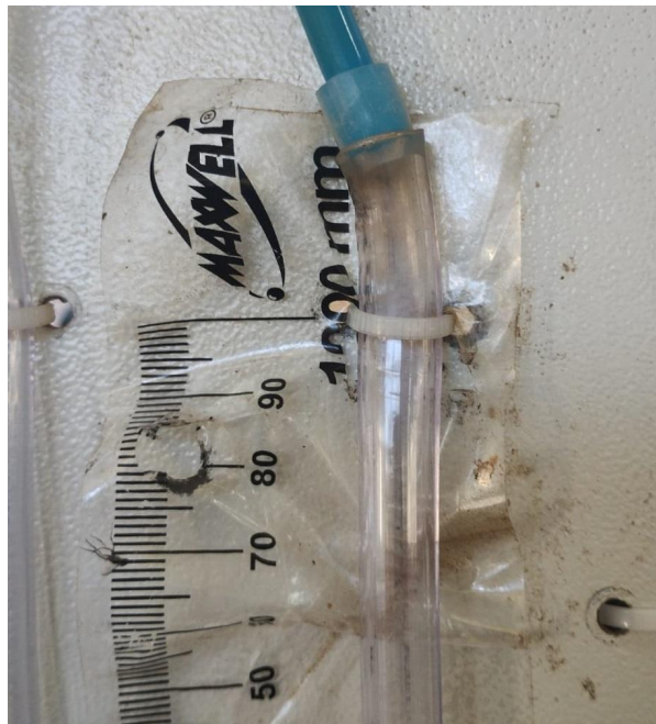
Figura 16 - Conexão Tubo em U do sistema fechado.
