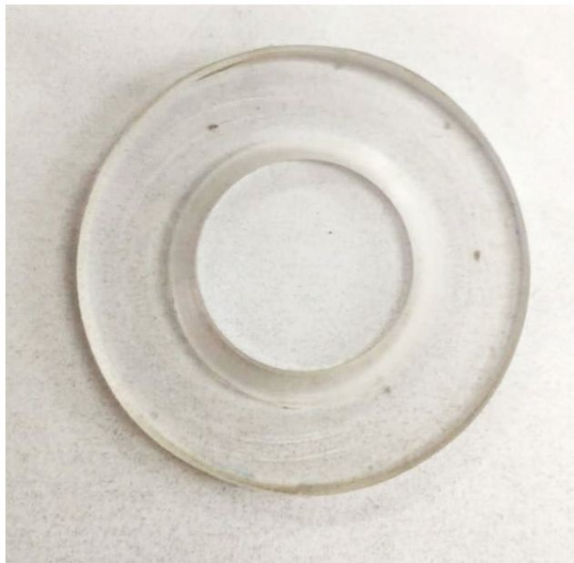
Figura 13 - Placa de orifício.
