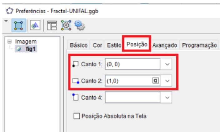
Figura 17 – Configuração da posição da imagem no Geogebra.
