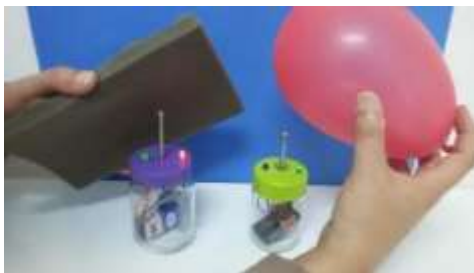
Figura 9 - Coulomboscópio de baixo custo. Fonte: (PEDROSO; PEDROSO; COSTA, 2017)
