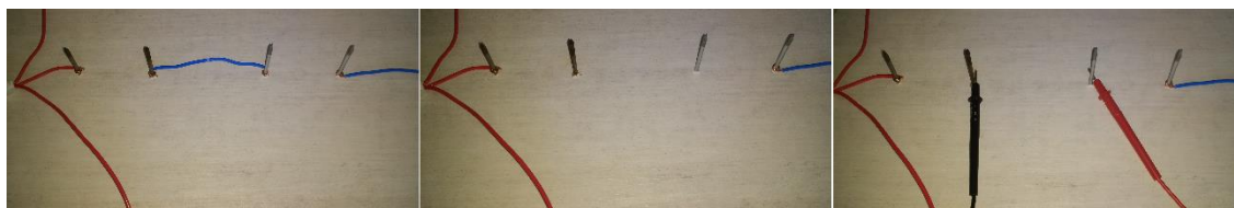
Figura 24 - Medida da Corrente Elétrica.
