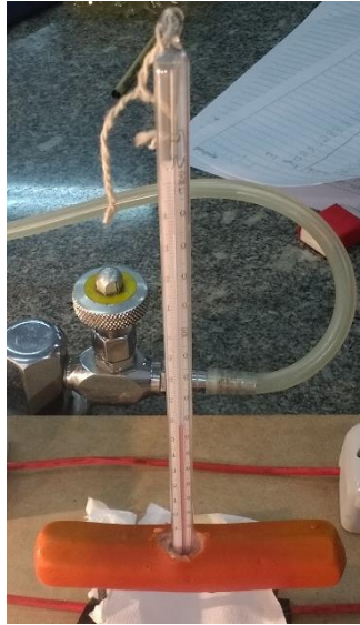
Figura 27 - Fixação do termômetro
