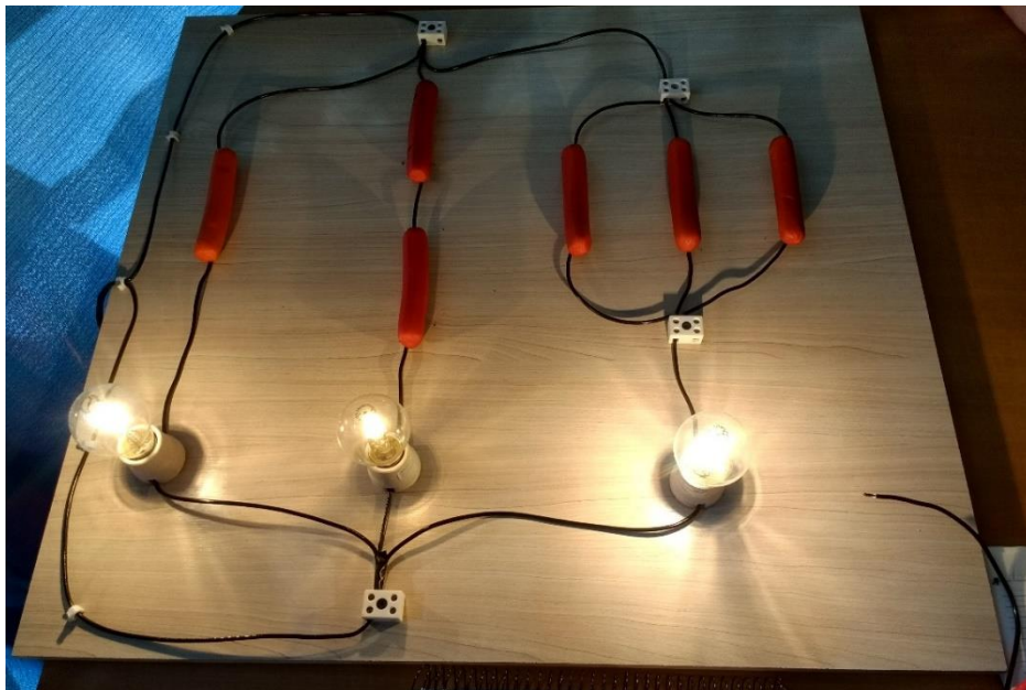
Figura 2 - Protoboard com resistores orgânicos
