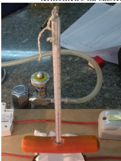
Figura 13 - Detalhe da inserção do termômetro na salsicha
