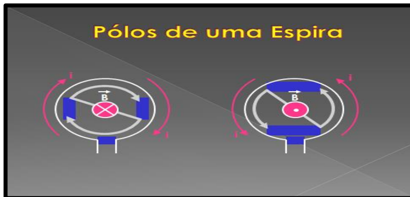
Figura 40 - Polos magnéticos de espira circular. Fonte: Pietra Da Silva.
