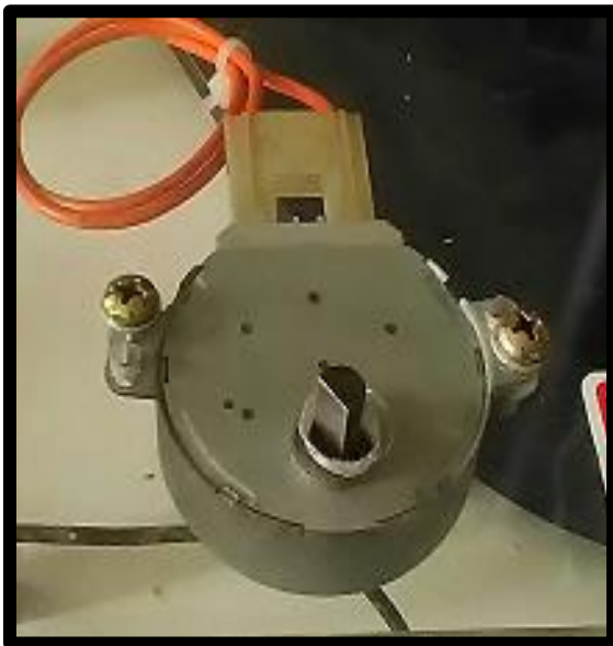
Figura 55 - Motor de micro-ondas. Fonte: Do próprio autor.
