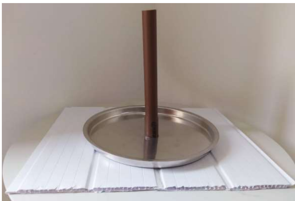
Figura 12 - Eletróforo de Volta de baixo custo.
