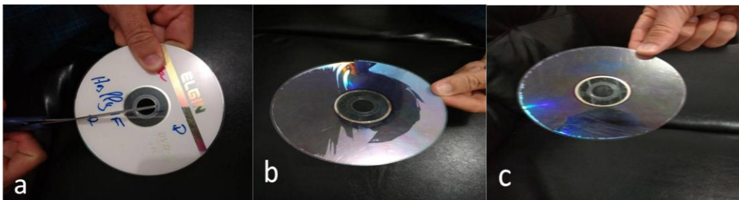
Figura 3. (a) Separação do DVD em duas partes, (b) Parte de baixo do DVD, (c) DVD com o centro tampado. Fonte: do Autor.
