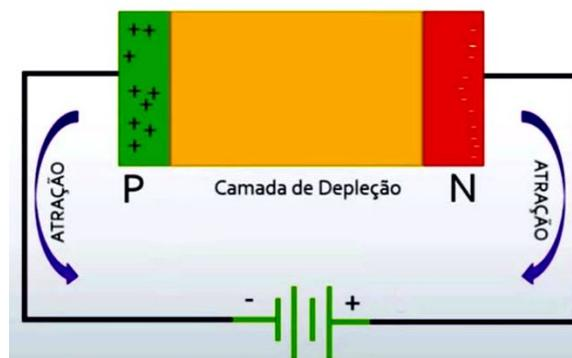
Figura 3 – Diodo polarizado reversamente.
