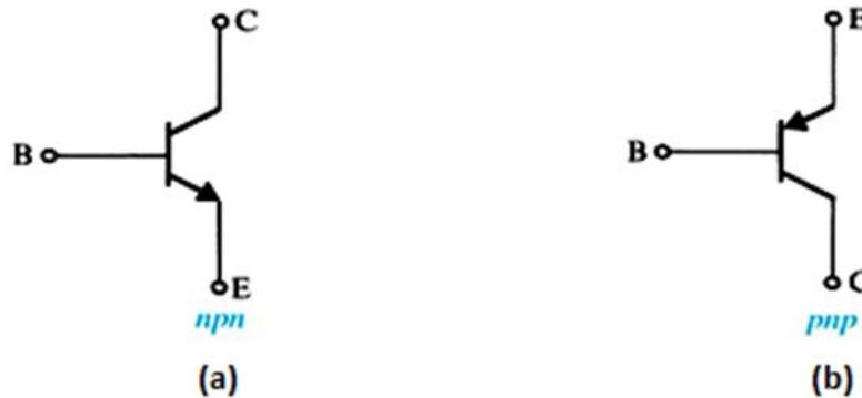
Figura 6 - Representações simbólicas de transistor bipolar.
