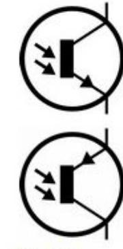
Figura 11 – Representação simbólica de um fototransistor.
