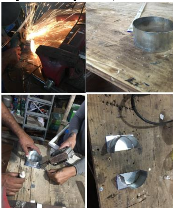
Figura 88 – Montagem dos espelhos esféricos
