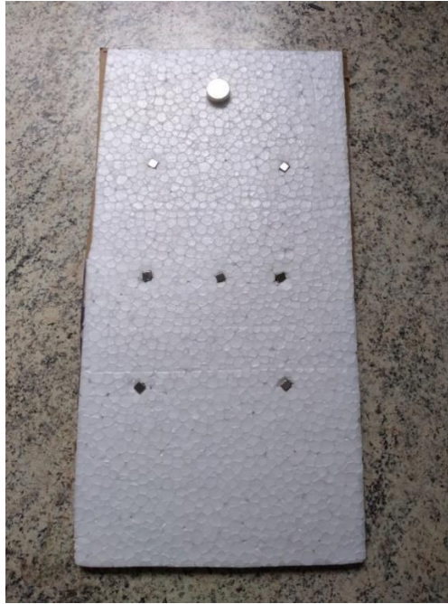
Figura 5: Aparato de isopor e papelão visto por baixo com os ímãs cúbicos posicionados e o ímã em forma de disco usado para “varrer” a superfície oposta do aparato. Fonte: Do autor.
