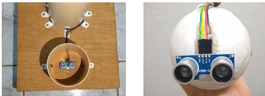
Figura 9: Fixação dos sensores ultrassônicos.
