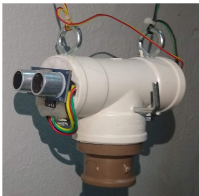
Figura 10: Massa do Pêndulo a base de cano P.V.C e gesso.
