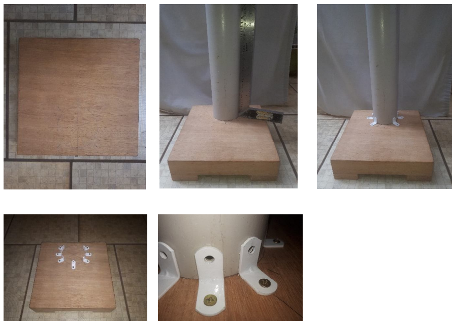
Figura 4: Sequência de montagem da base mais o suporte principal.
