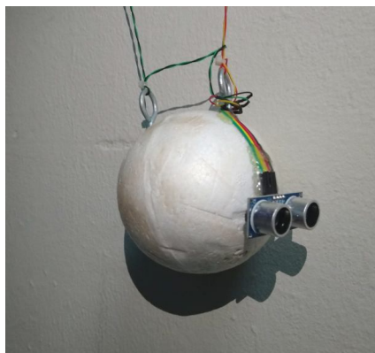
Figura 11: Nova massa do Pêndulo, a base de isopor e gesso
