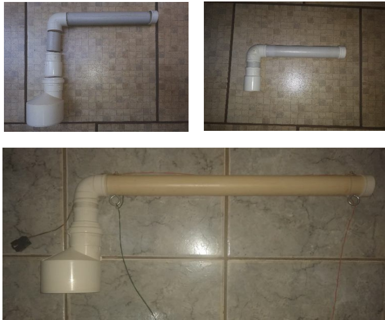
Figura 6: Montagem do suporte espaçador.
