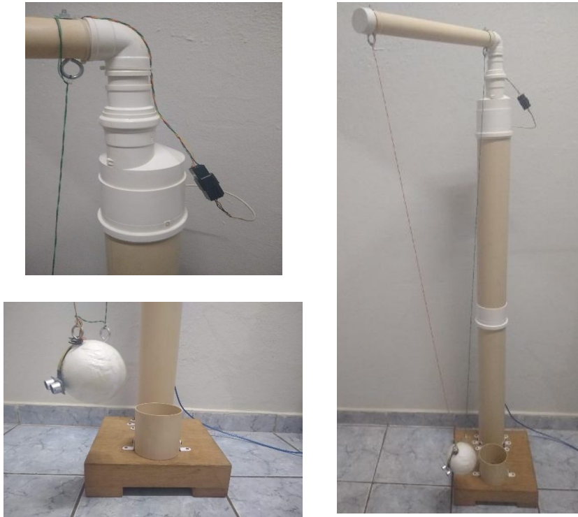
Figura 7: Detalhe Plug automotivo, Detalhe fixação da massa do pêndulo, e vista completa do experimento pêndulo montado.
