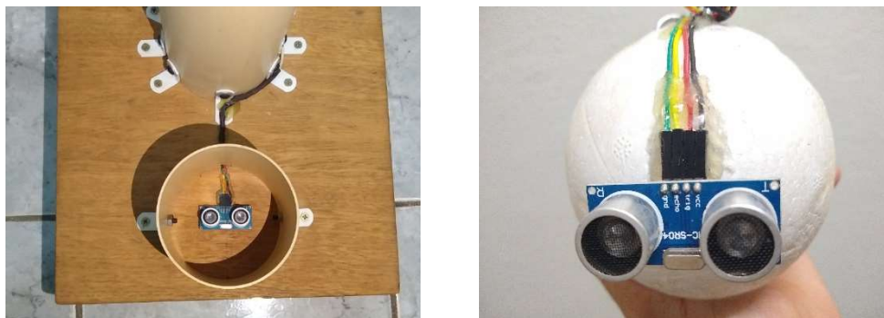
Figura 30: Fixação dos sensores ultrassônicos.
