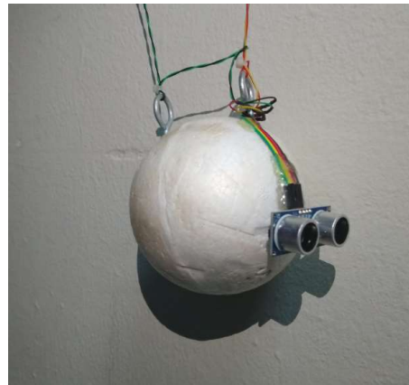
Figura 32: Nova massa do Pêndulo, a base de isopor e gesso
