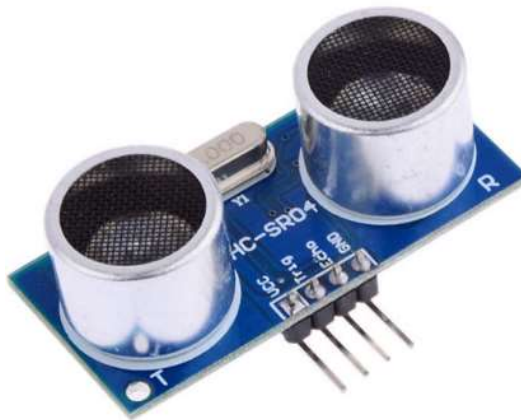
Figura 18: Sensor de Distância Ultrassônico HC-SR04.
