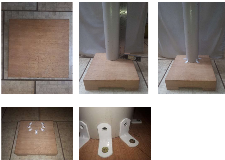
Figura 25: Sequência de montagem da base mais o suporte principal.
