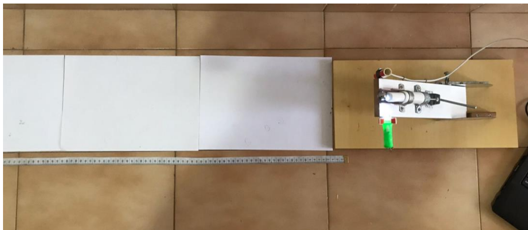
Figura-05: Vista superior do lançador de projéteis e as folhas de papel sulfite para determinar o local em que a esfera caiu.
