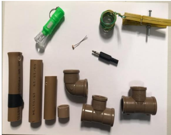
Figura 9: Componentes utilizados para a construção do fotogate .
