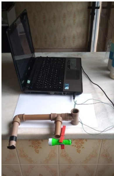
Figura-05: Fotogate posicionado para coleta de dados, com o P2 conectado no computador para utilização do software AUDACITY .
