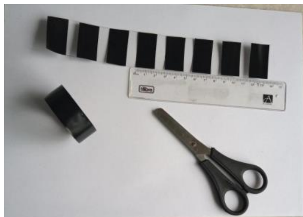
Figura 15: Picket Fence de baixo custo construída.
