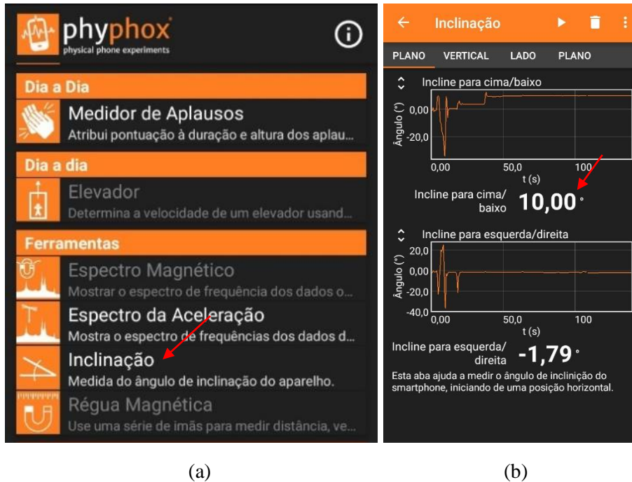
Figura-03: (a) Captura da tela inicial do aplicativo Phyphox na sessão “Ferramentas”. (b) Captura de tela mostrando as configurações iniciais e o resultado obtido pela autora para inclinação inicial do plano.
