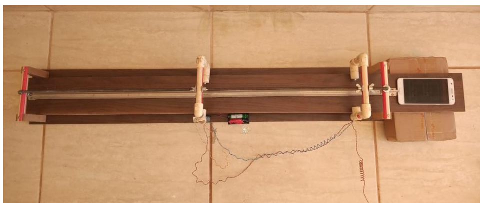
Figura-02: Vista superior do experimento mostrando a forma de como deve posicionar o smartphone para obter a inclinação do plano.
