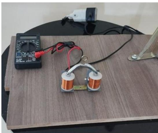
**Figura 4-4.** Experimento: Eletroímã. (Fonte: autor)
