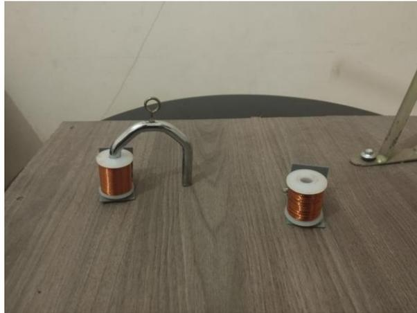
**Figura B-14.** Bobinas sendo acopladas na estrutura metálica. (Fonte: autor)
