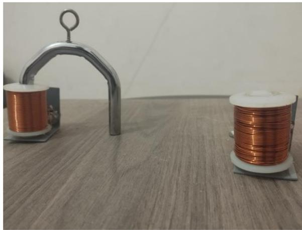
**Figura B-13.** Estrutura Metálica e bobinas de cobre dispostas sob a base de madeira
