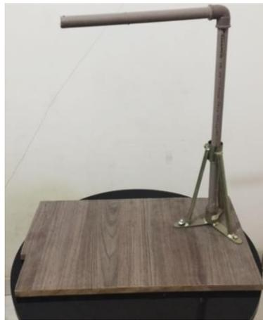
**Figura B-6.** Fixação da estrutura de PVC ao suporte. [Fonte: autor]
