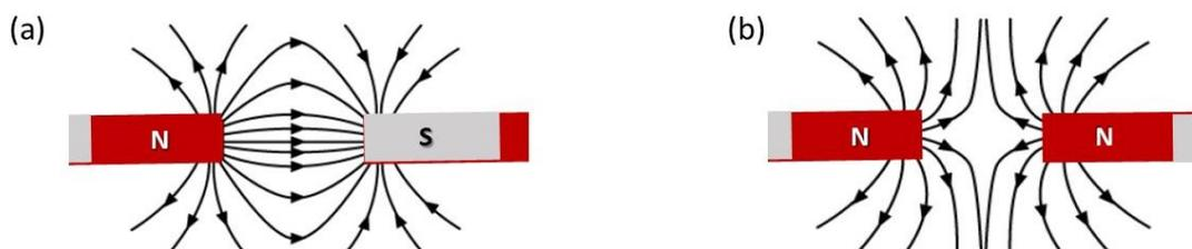
**Figura A-15.** Interação entre as linhas de campo magnético. (a) conexão das linhas de campo do polo sul para o norte de outro ímã. (b) não interação entre as linhas de campo magnético.
