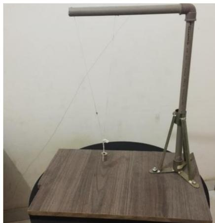
**Figura B-8.** Linha de Nylon passada ao orifício do cano de PVC. [Fonte: autor]
