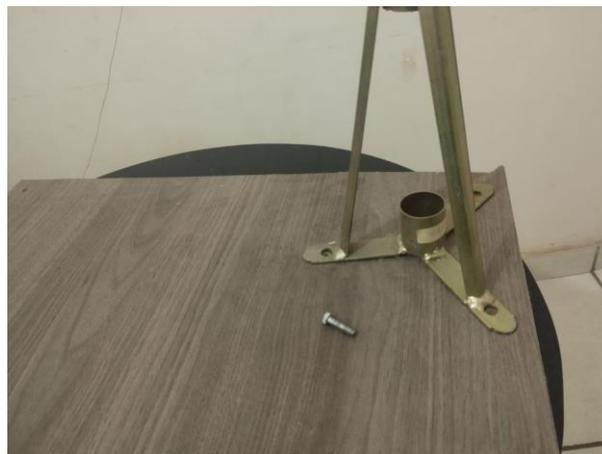
**Figura B-2.** Marcação dos furos na base de madeira. [Fonte: autor]
