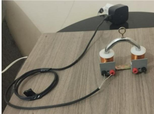
**Figura B-16.** Carregador conectado nos terminais de uma das bobinas. (Fonte: autor)
