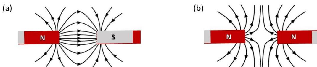
**Figura 10-15.** Interação entre as linhas de campo magnético. (a) conexão das linhas de campo do polo sul para o norte de outro ímã. (b) não interação entre as linhas de campo magnético.
