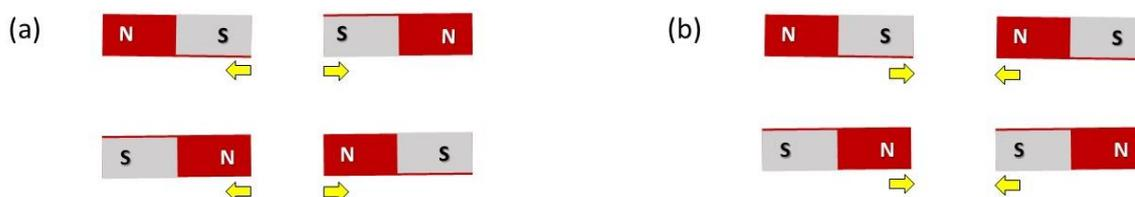
**Figura 10-10.** Interação entre os polos. (a) polos de mesmo nome se repelem. (b) polos de nomes diferentes se atraem. [Fonte: autor]
