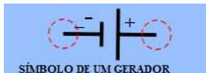
Quando verificamos a tensão elétrica entre os dois polos de um gerador, obtemos uma grandeza que chamamos de força eletromotriz (f.e.m.) que é representada pela letra grega  $\mathcal{E}$  (Epsilon).
