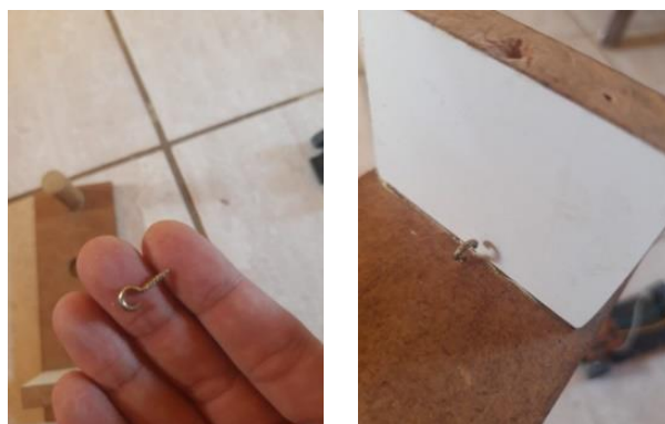
FIGURA 04 – Fixação do parafuso que irá segurar o elástico.
