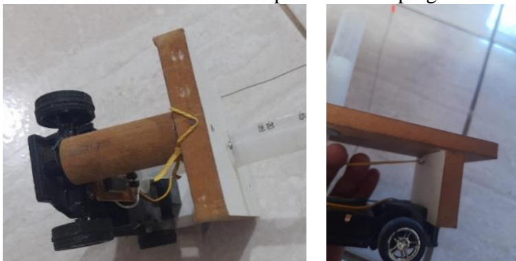
FIGURA 07: Prendendo o elástico no parafuso e no prego.
