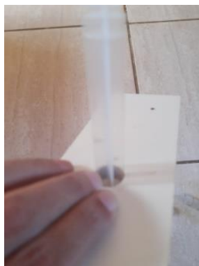
FIGURA 05: Colocação do embolo no buraco.
