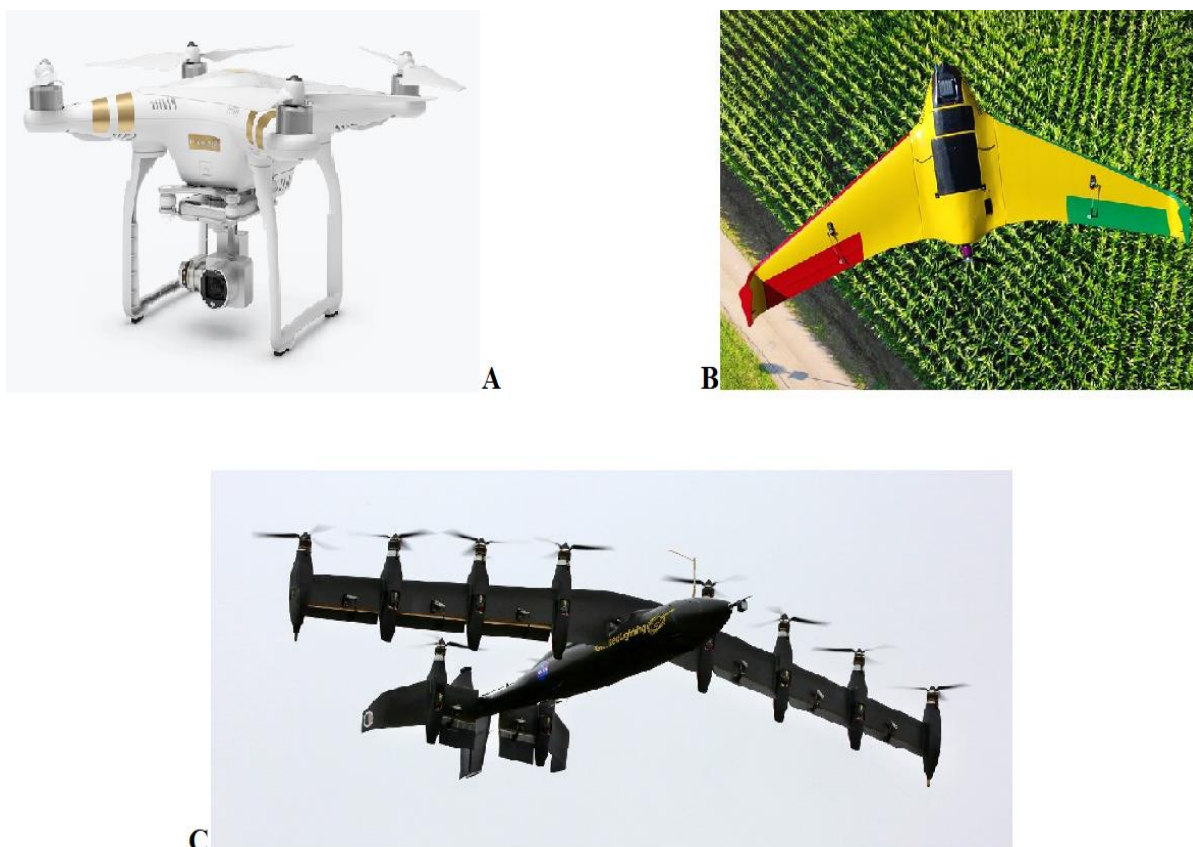
Figura 2 – A) Modelo de Drone multirrotor; B) Modelo de Drone asa fixa; C) Modelo de Drone híbrido.
