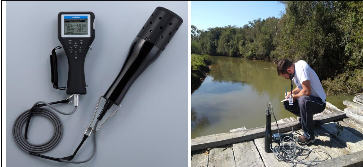
Figura 10. Medidor portátil U-50 Multiparameter Water Quality Checkers Horiba.
