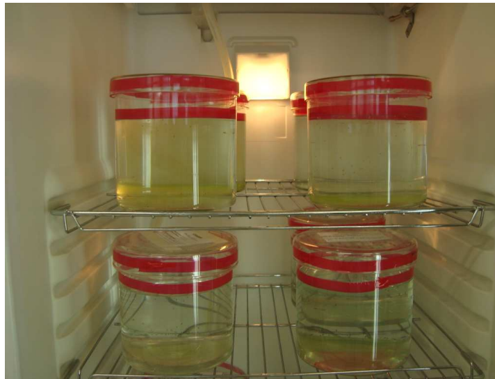
Figura 5: Cristalizadores e estufa incubadora tipo B.O.D. utilizados no cultivo de D. similis .
