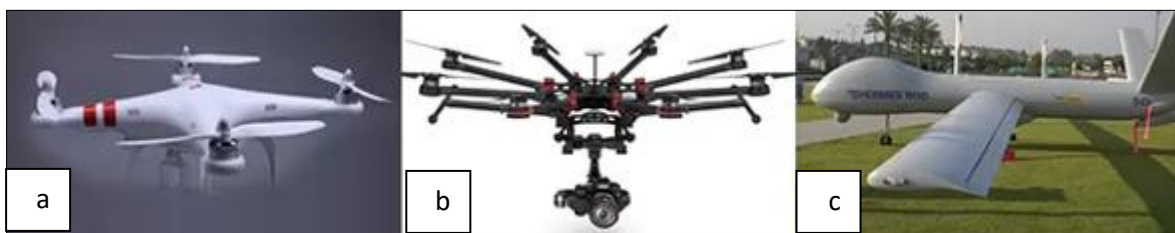
Figura 2 - Tipos e modelos de VANT segundo classificação da ANAC: (a) categoria 3, (b) categoria 2 e (c) categoria 1.
