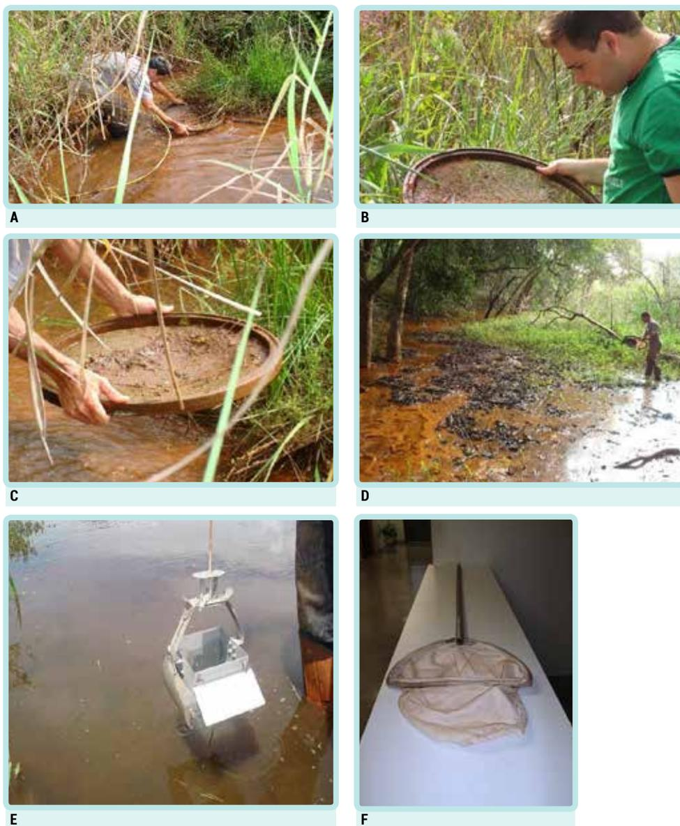
**Figura 1.** A a F: Equipamentos utilizados na coleta de invertebrados aquáticos para a obtenção da massa necessária para análises de metais; A a D: Peneira; E: Draga de Ekman-Birge; F: Rede em “D”.
