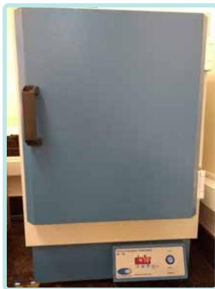
**Figura 3.** Equipamento utilizado no processo de secagem da fauna de invertebrados aquáticos, em análises de metais. Estufa de secagem em temperatura de até 60°C. Fonte: próprio autor.
