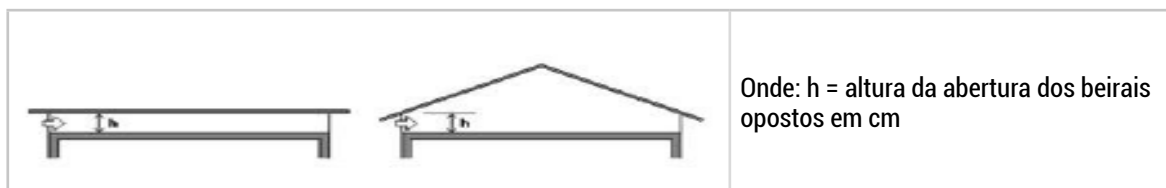
Figura 4. Desenho esquemático de cobertura para cálculo do Fator de Ventilação. Fonte: NBR 15575-5 (2013).
