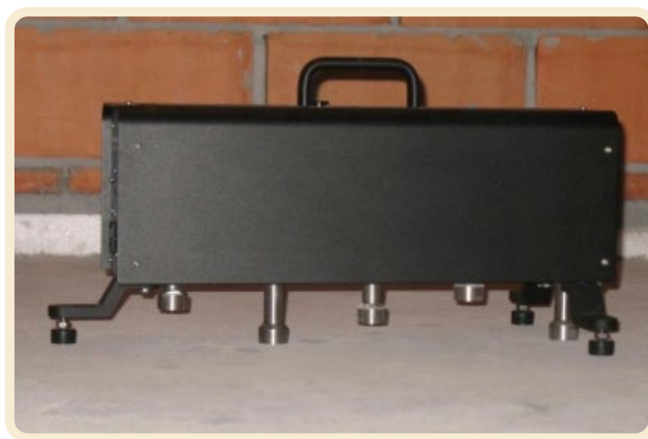
Figura 6. Máquina empregada para avaliação do isolamento de ruído de impacto (Fonte: SINDUSCON-RIO, 2013).
