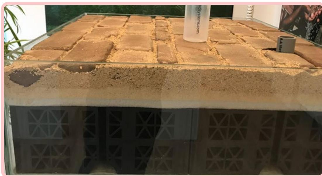
**Figura 5.** Estrutura de um pavimento permeável.
