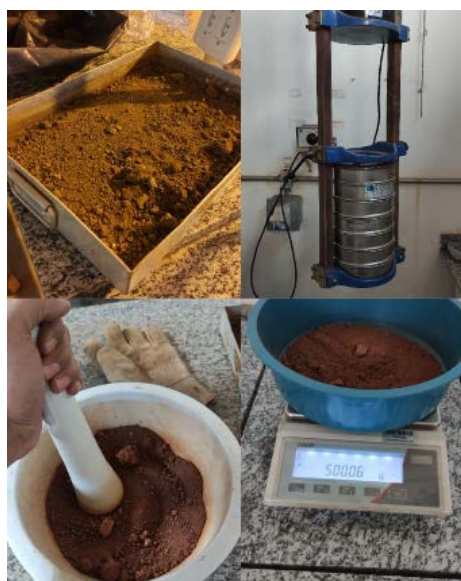
Fotografia 6 - Registros do experimento de análise granulométrica.
