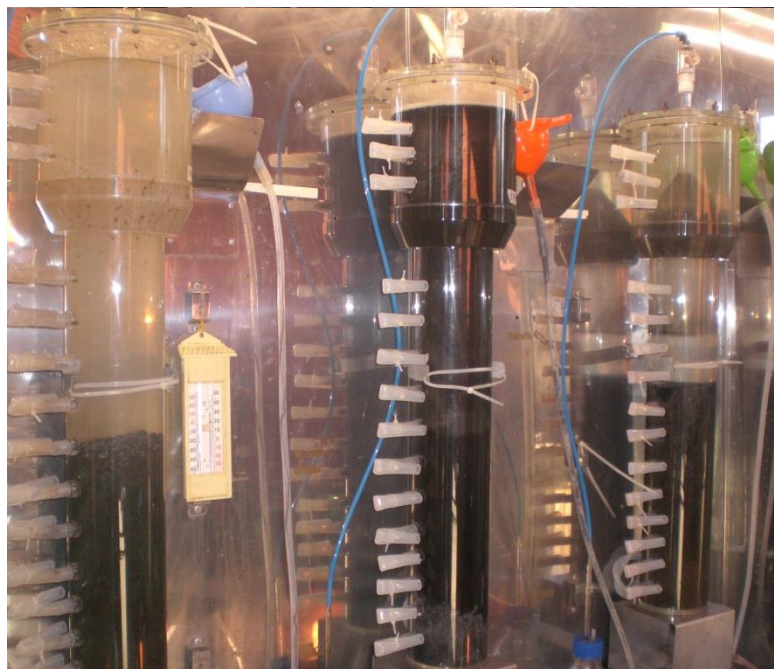
Figura 4.2 Foto dos reatores UASB instalados em câmara de controle de temperatura. Fonte: Do autor.
