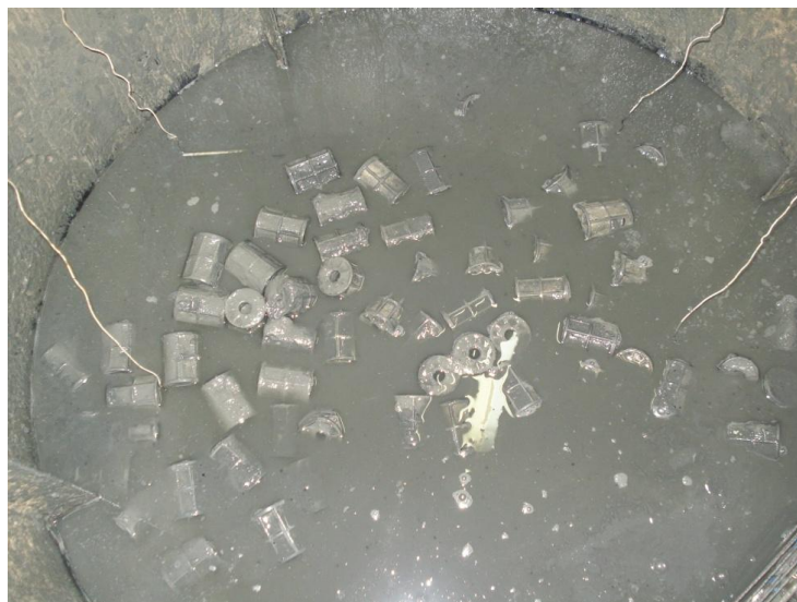
Figura 17 - Biobob® com biomassa aeróbia inoculada em reator em batelada sequencial.
