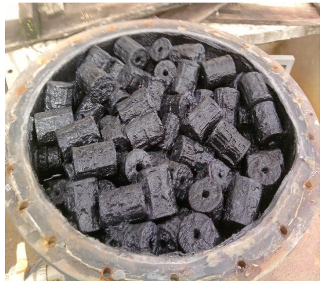
Figura 20 - Biorreator anóxico-aeróbio. (a) Esquema do biorreator anóxico-aeróbio de leito fixo com recirculação da fase líquida a ser modelado e simulado; (b) sistema de aeração (difusor); (c) foto de um suporte (individual) para biomassa; (d) suportes inoculados distribuídos aleatoriamente no reator.
